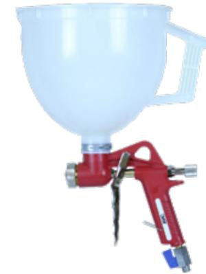
Für Spritzputze bis max. 3 mm Korngröße, sowie für flüssige Raufaser und hochviskose Materialien. Drei auswechselbare Düsen von 4,5 - 6 und 8 mm Durchmesser für unterschiedliche Strukturen. Serienmäßiger Material- und Luftdurchgangsregler mit Absperrventil.
