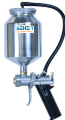
Die vielseitige Spezialspritzpistole zur Verarbeitung von Multicolorfarben, flüssige Raufaser, Spritzputz und vielen weiteren gefüllten Materialien. Mit 4 Düsen, 3 unterschiedlichen Luftköpfen und einem ergonomisch geformten Isolierhandgriff mit eingebautem Luftregler. 1,5 l Alu Fließbecher serienmäßig. Auch mit 2,5 l Alu-Fließbecher lieferbar. Damit steht einer plastischen Flächengestaltung nichts mehr im Wege.
